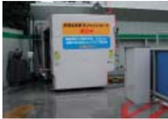
洗車水リサイクル型洗車機
